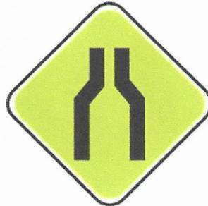
**P-18B. Estrechamiento asimétrico de la carretera.** Se instalará para indicar al conductor la reducción de la carretera debido a la ocupación temporal de un (1) lado de la calzada, así como cuando haya material depositado a la derecha. También se utilizará para indicar una reducción de carriles o simplemente de las dimensiones de la sección transversal. El símbolo invertido se instalará para indicar la transición del lado izquierdo.
