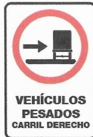
**R-20. Desvío camiones.** Se instalará para indicar que existe un desvío para vehículos pesados. Se colocará una (1) primera señal de acuerdo a las especificaciones generales de situación de las señales de prevención, y otra en el propio sitio del desvío. La dirección del desvío se indicará mediante una flecha colocada en la propia señal.
