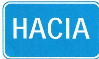
**I-21. Conjuntos direccionales.** Este tipo de señales se enmarcan dentro del grupo de “Señales de Información General”, por lo que servirán de orientación para transmitir mensajes a través de ellas.
