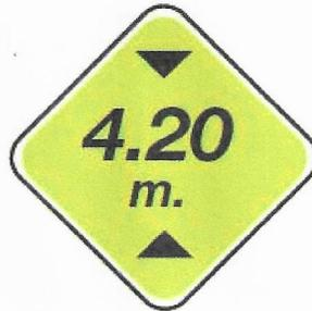
**P-32. Ancho limitado.** Se instalará para advertir al conductor que el espacio libre horizontal es el indicado y que el ancho máximo permisible en el vehículo debe ser menor que el señalado, de forma que éste pueda pasar con seguridad. En la parte media de la placa se anotará la altura libre, aproximada al décímetro inferior. En zonas urbanas se colocará inmediatamente antes del punto de peligro; en zonas rurales se colocará después de la señal P-19.
