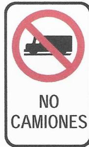
**R-9. No vehículos de motor.** Se instalará a la entrada y antes de cada acceso de todas aquellas vías donde por sus características de diseño o función no se permita el paso de vehículos automotores.
