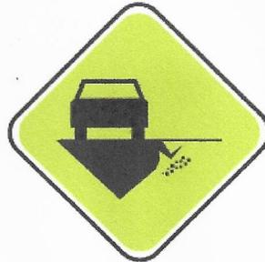
**P-26. Proyección de gravilla.** Se instalará para indicar a los conductores de vehículos la proximidad de un tramo del camino con grava o piedras sueltas que pueden ser disparadas por las llantas de los vehículos.
