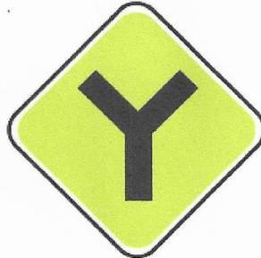
**P-10A y P-10B. Intersección lateral oblicua derecha e intersección lateral oblicua izquierda.** Se instalará para indicar la proximidad de una intersección con un camino lateral a la derecha o izquierda, formando un ángulo menor de noventa grados ( $90^\circ$ ). Se utilizará la señal P-10A si la intersección queda en la derecha en sentido de avance, y P-10B si la intersección queda a la izquierda en sentido de avance.
