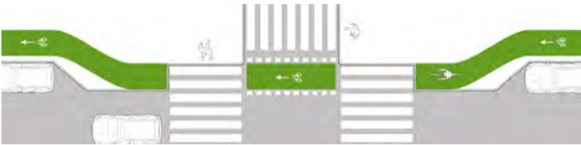
Imagen III. 41. Giro de la ciclovía para facilitar su continuidad adosada a la calzada general
