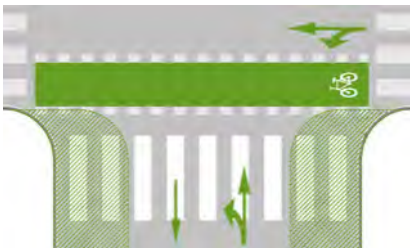
Imagen III. 36. Orejas peatonales en cruces con calles de dos sentidos de circulación
