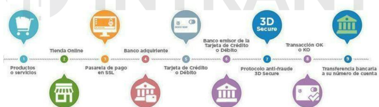
Figura 79. Flujo de funcionamiento de una pasarela de pago
