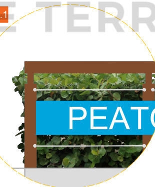
C 4 Detalle cruce peatonal en mediana Av. Abraham Lincoln esq. John F. Kennedy Baranda peatonal compuesta de bolardos de 0.90 m de altura, espaciados a 1.00 m que dirige a los peatones al cruce peatonal, acompañado de una valla informativa con el mensaje que se presenta en el detalle.
