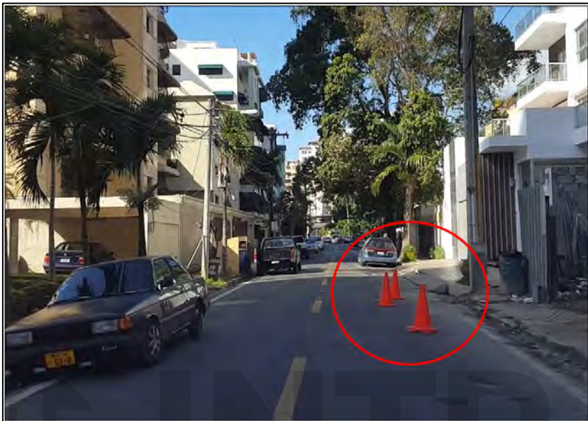
Figura 8: Cono de tráfico colocados de forma irregular.
