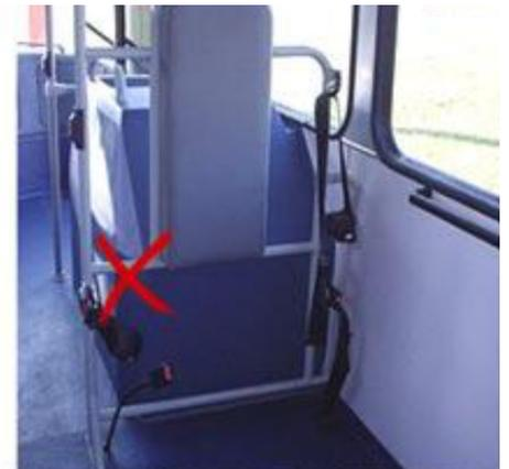
Espacio para silla de ruedas señalizado, con respaldar y cinturón de seguridad.
