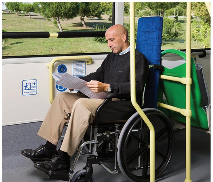
Espacio para silla de ruedas señalizado, con respaldar y cinturón de seguridad.
