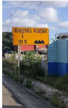
La Señalización Vertical utilizada para indicar la proximidad de reductores de velocidad tipo Lomo y Estoperoles poseen simbologías diferentes, algunas fuera de los estándares, incluyendo la Señal de Semáforo colocada próximo al Parque Industrial Santiago-Norte (PISANO), en el tramo de vía Santiago - Villa González, como se muestra en las imágenes.
